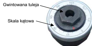
Rys. 1 Urządzenie poddawane kontroli obciążenia
